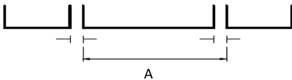
Bild 59 - Beispiel Modulmaß der Decklage
