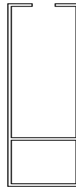
Bild 27 - Beispiel Doppelwandige Lamelle / Baffel aus gepresstem Aluminium
