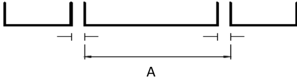
Bild 59 - Beispiel Modulmaß der Decklage
