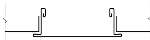
Bild 10 - Beispiel Bandrasterystem mit Auflage-Bandrasterprofil
